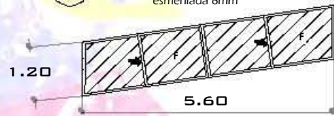
8 Ventanas aulas. ventanas abatibles de 0.65 x2.20 , aluminio natural 2" y cristal claro con pelicula esmerilada 6mm
