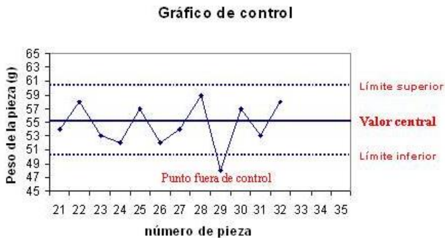
Figura 2.6. Esquema de un gráfico de control
