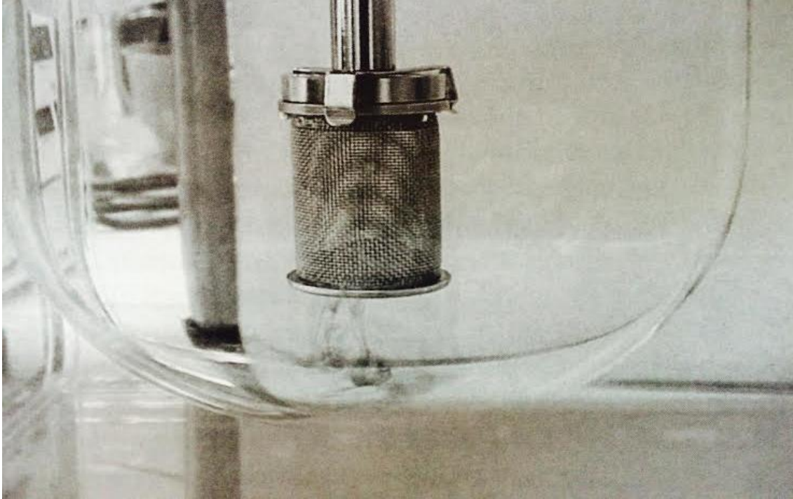
Figura 2. Aparato 1 USP (canastilla) Sistema cerrado de agitación continua con un vaso de 1000 mL inmerso en un baño de agua a temperatura controlada. Una descripción detallada del sistema se encuentra en la actual versión de la USP. Adaptado de la referencia 5. 2011 derechos reservados Sinko J. Martin's physical pharmacy and pharmaceutical sciences: physicalchemical and biopharmaceutical principles in the pharmaceutical sciences.
