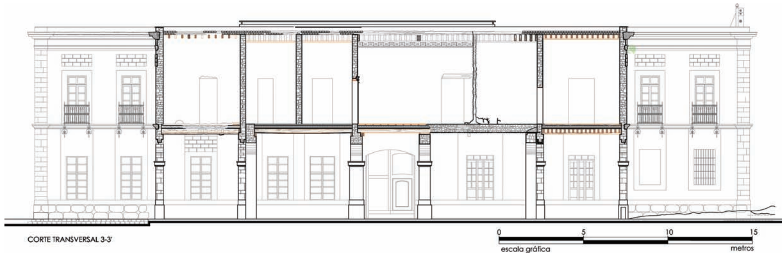
Fig.117 Corte transversal donde se aprecia ls cubiertas colapsadas del mesón Arroyo Zarco.
