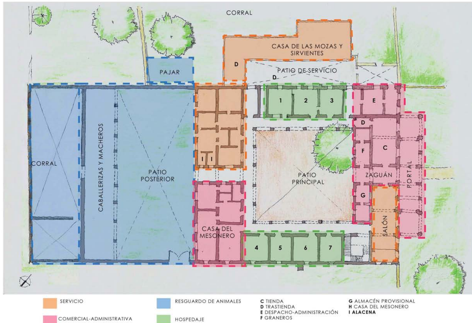
Fig. 82 Planta baja Mesón Arroyo Zarco. En este dibujo se identificaron los usos de los espacios que pudo tener el mesón con ayuda del análisis en sitio, los relatos de los cronistas y la comparación con otros edificios análogos. Dibujo Isis Isidoro, 2013.
