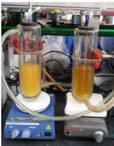
Figura 4. Tubos de fermentación #1 (izquierda) condiciones con agitación, y el #2 (derecho) condiciones sin agitación, ambos con recirculación de agua a una temperatura de 40 °C
