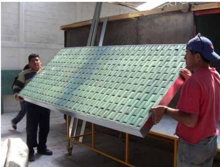
**Ilustración 2 Muro prefabricado con plástico Sistema cero's México**
