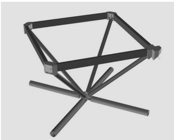
Imagen 20. Du Château. Módulo del sistema UNIBAT, conformado por barras metálicas unidas a nodos de ensamble sencillo.
