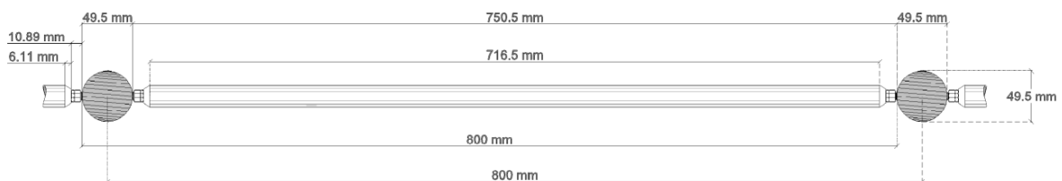
Imagen 79. Conexión de la barra a los nodos esféricos con las dimensiones establecidas para el proyecto, según el cálculo de barras de 75.5 cm de longitud.
