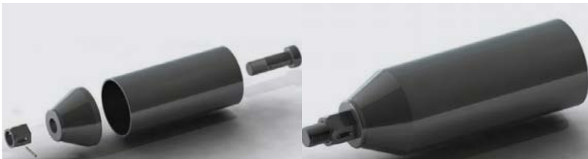
Imagen 68. Modelo tridimensional de la composición y ensamblaje de la barra del sistema KK de MERO.
