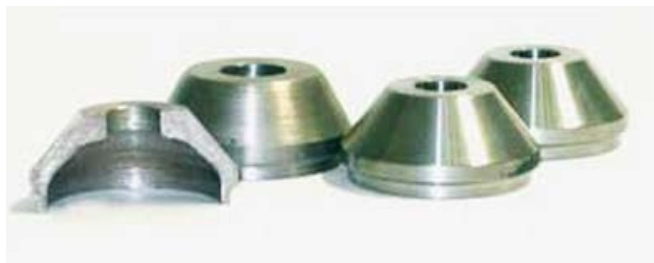
Fotografía 41. Casquillos cónicos de las barras del sistema Ortiz de Lanik, se observa en uno de ellos, la sección interna del casquillo.
