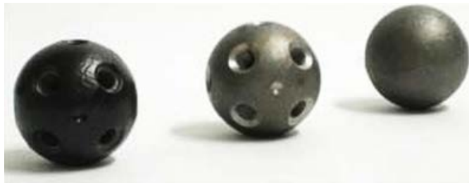
Fotografía 40. Proceso de fabricación del nodo esférico del sistema Ortiz de Lanik: elaboración de pieza esférica de acero al carbono, proceso de taladro de orificios, protección superficial (pintura).
