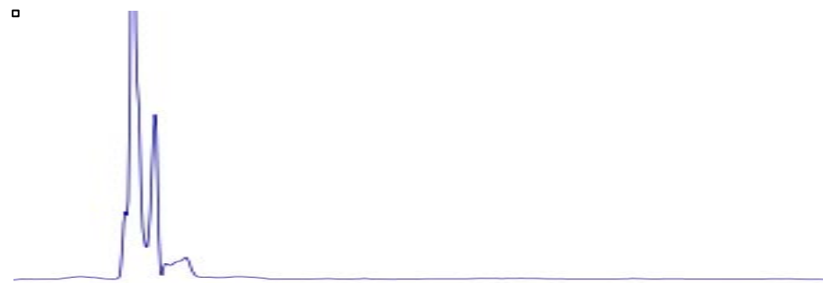
Fig. 15 Cromatograma de la Cafeína de la prueba de selectividad de fármacos de uso común y concomitantes para MAA/meloxicam
