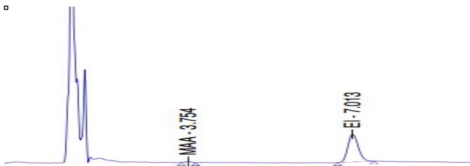
Fig. 22 Cromatograma LIC para la prueba precisión y exactitud para MAA/meloxicam.
