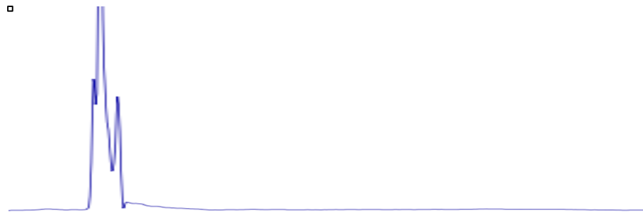
Fig. 20 Cromatograma del segundo Doble blanco para la prueba de acarreamiento para MAA/meloxicam.
