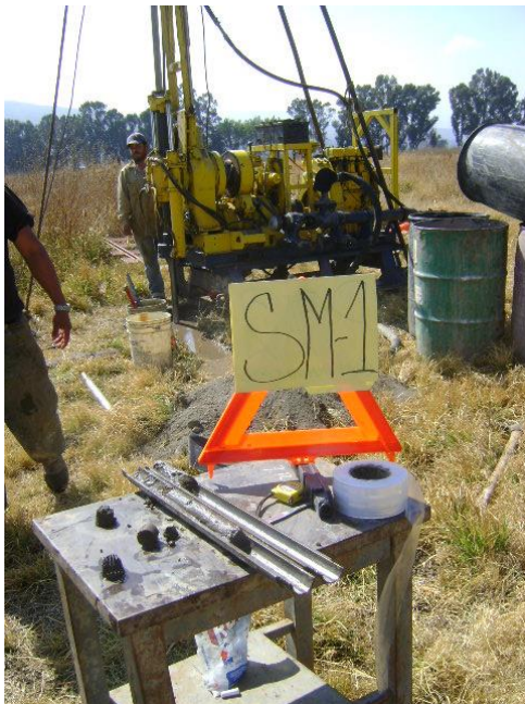
IMAGEN DE MUESTRA ALTERADA OBTENIDA CON TUBO PARTIDO, PREVIO A SER EMPACADAS PARA SU TRASLADO AL LABORATORIO CENTRAL.
