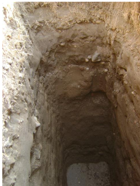
EN LA IMAGEN SE APRECIA LA ESTRATIGRAFÍA PROPIA DEL SITIO, LA CUAL SE ENCUENTRA CONSTITUIDA EN SUS PRIMEROS METROS POR UNA ARENA LIMOSA.
