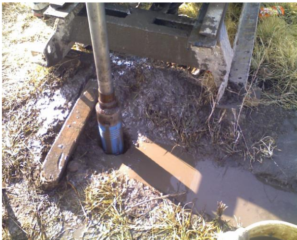
MOMENTOS EN QUE EL TUBO SHELBY ES EXTRAÍDO CON LA MUESTRA OBTENIDA.
