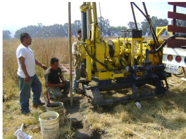
SECCIONAMIENTO EN LA TUBERÍA PARA VERIFICAR EL NUMERO DE GOLPES QUE Oponen LOS MATERIALES EN LOS 60CM PENETRADOS.
