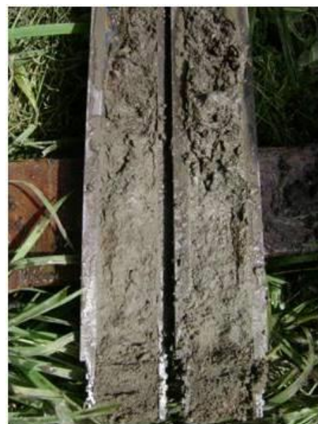
EJECUCIÓN DE SONDEO PROFUNDO Y OBTENCIÓN DE MUESTRAS
