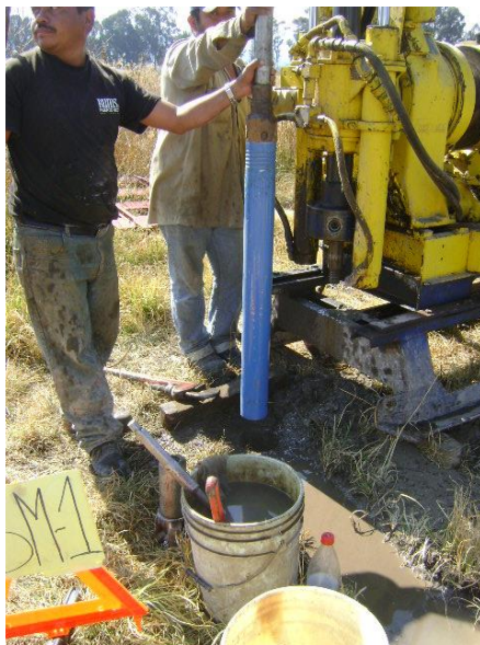
EJECUCIÓN DE SONDEO PROFUNDO Y OBTENCIÓN DE MUESTRAS
