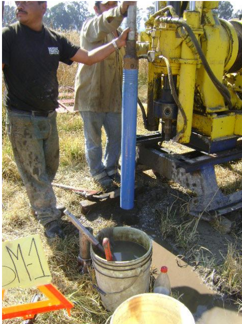
VISTA DEL MUESTREADOR DE PARED DELGADA (SHELBY), PREVIO A SER HINCADO A PRESIÓN PARA LA OBTENCIÓN DE UNA MUESTRA INALTERADA.
