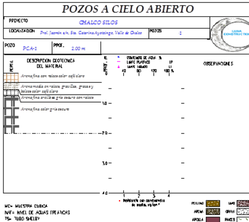
FIGURA 6. PERFIL ESTRATIGRAFICO POZO A CIELO ABIERTO
