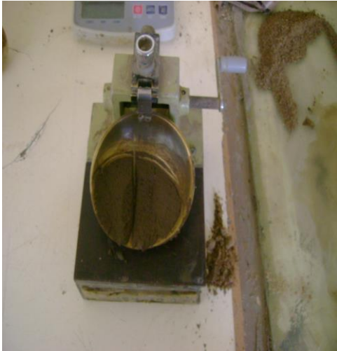
PRUEBA LIMITE DE CONSISTENCIA
