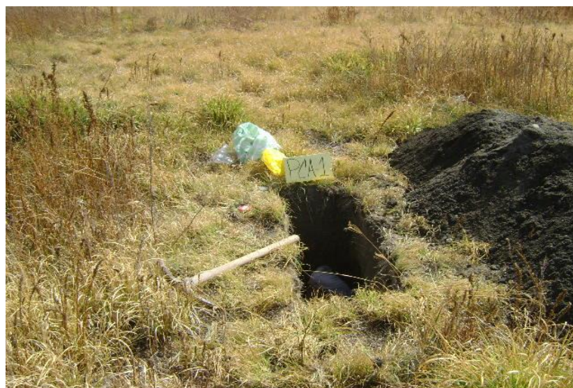
SONDEO PROFUNDO Y POZO A CIELO ABIERTO
