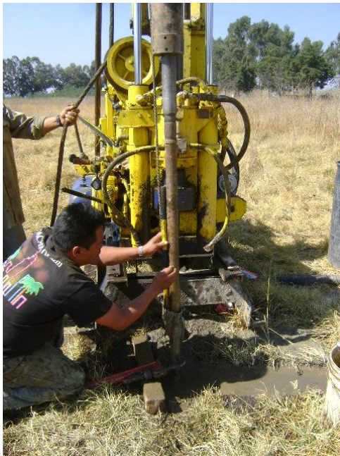
SECCIONAMIENTO EN LA TUBERÍA PARA VERIFICAR EL NUMERO DE GOLPES QUE Oponen LOS MATERIALES EN LOS 60CM PENETRADOS.
