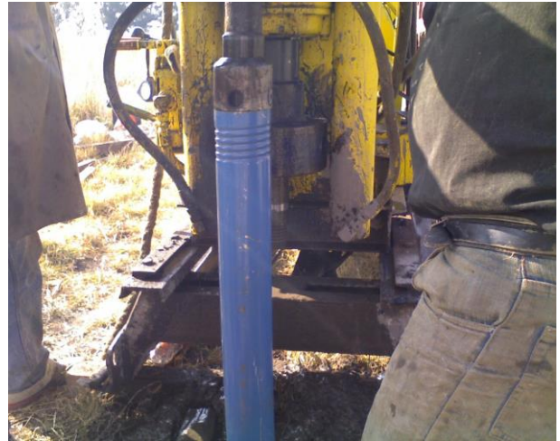
VISTA DEL MUESTREADOR DE PARED DELGADA (SHELBY), PREVIO A SER HINCADO A PRESIÓN PARA LA OBTENCIÓN DE UNA MUESTRA INALTERADA.
