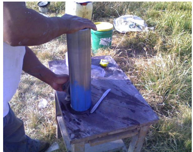
TUBO SHELBY UNA VEZ QUE ES PROTEGIDO PARA SER ENVIADO AL LABORATORIO CENTRAL
