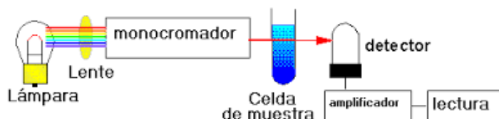
Figura No. 42 a. Se presenta un esquema básico de los componentes de un espectrofotómetro UV-Vis.
