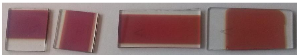
Figura No. 24. Películas obtenidas mediante evaporación física
