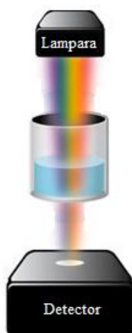
Figura No. 42 b. Muestra un esquema del espectrofotómetro que se tiene en el laboratorio.
