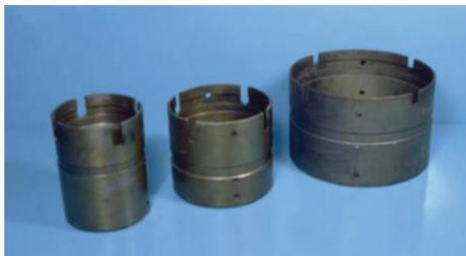
Figura 34 Casquillos de desgaste. Fuente: Petroleum Engineering Handbook Vol. II, Larry W. Lake.
