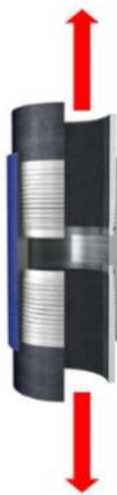
Figura 18 Representación gráfica de la tensión. Fuente: Conceptos generales de conexiones TENARIS –TAMSA. Modificada por el autor.
