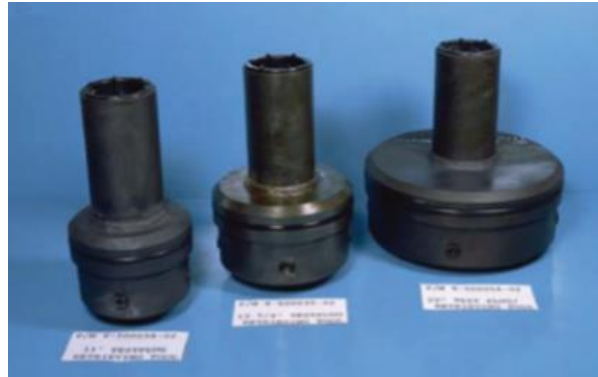
Figura 35 Herramienta para correr sellos de desgaste. Fuente: Petroleum Engineering Handbook Vol. II, Larry W. Lake.
