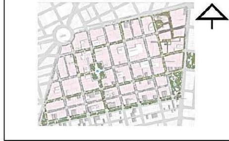
Con el propósito de reducir los problemas en las banquetas de toda la poligonal, provocados por el arbolado de raíz agresiva, se propone aumentar la dimensión de los cajetes.
