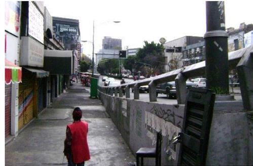
Imagen 1. Av. Insurgentes. En la imagen se observa como la rampa de Insurgentes y los edificios hacen de la acera peatonal una especie de “canal” que evita la salida del agua.
