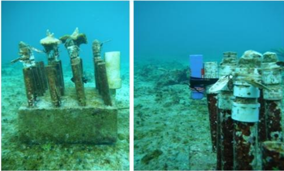
Figura 9. Trampa de sedimento colocada en la plataforma “F” (izquierda) y sensor de Luz colocado en la plataforma “D” (derecha) en el vivero marino.
