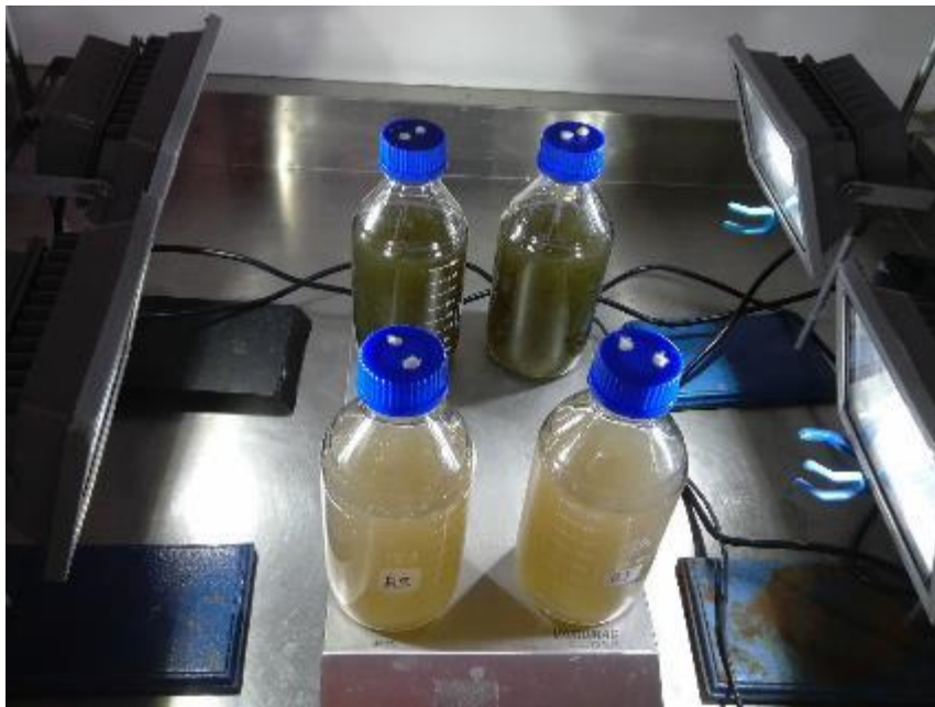
Figura 9 Montaje de reactores con inóculo maduro de microalgas y bacterias y lodo activado. Volumen de reactores: 0.9 L. Agitación magnética: 150 – 200 rpm.
