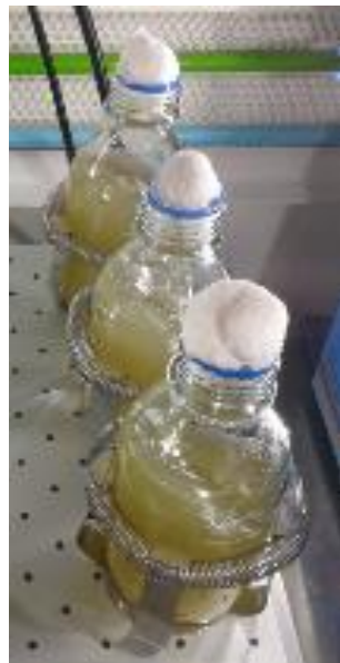
Figura 5 Montaje experimental de la fase de estabilización. Volumen de reactores: 450 mL. Agitación orbital: 160 rpm.
