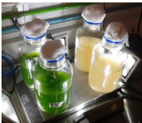
Figura 4 Montaje experimental prueba de remoción de nutrientes y materia orgánica en agua residual municipal. Volumen de reactores: 1.6 L. Agitación magnética (150 – 200 rpm).
