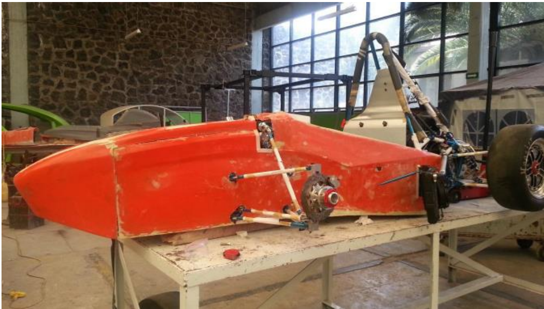
Figura 6.38 Manufactura de la carrocería 2013. Presentación de la nariz y laterales al coche para afinar detalles.
