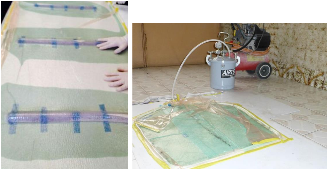
Figura 7.72 Proceso de infusión sobre un plano para el piso de la carrocería (izquierda) y para el piso de los ductos laterales (derecha) de la carrocería 2014.
