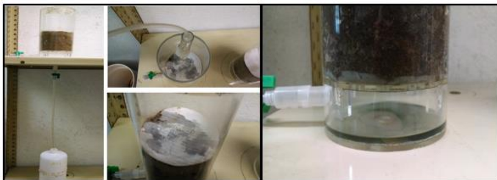
Figura 18. Equipo montado de las columnas de lixiviación Columnas de Lixiviación
