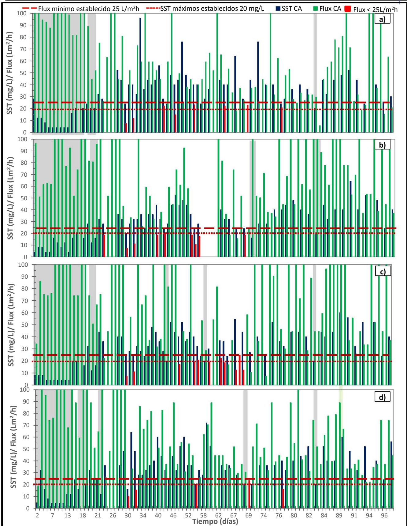
Figura 4.42. Variación de flux y sólidos suspendidos totales, a) cámara CA, b) cámara CB, c) cámara CC, y d) cámara CD. En sombreado gris, periodos de filtración efectiva con calidad y productividad deseadas.
