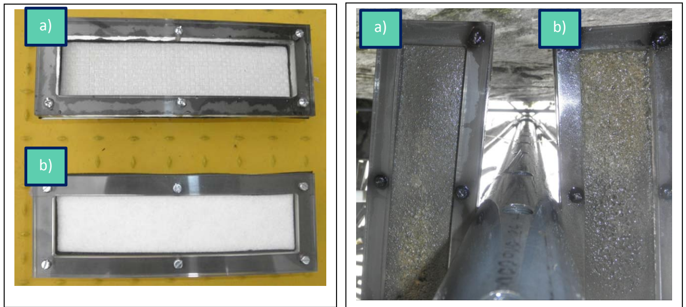
Figura 4.19. Módulos rectangulares con soportes primarios limpios y con las membranas formadas a) Polipropileno poliéster, b) polipropileno ( 50\mu\text{m} )
