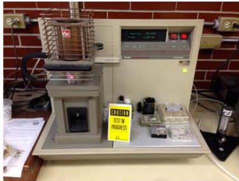
**Fig. 3.8.** Analizador termomecánico TMA 2940 de TA Instruments. <sup>[13]</sup>
