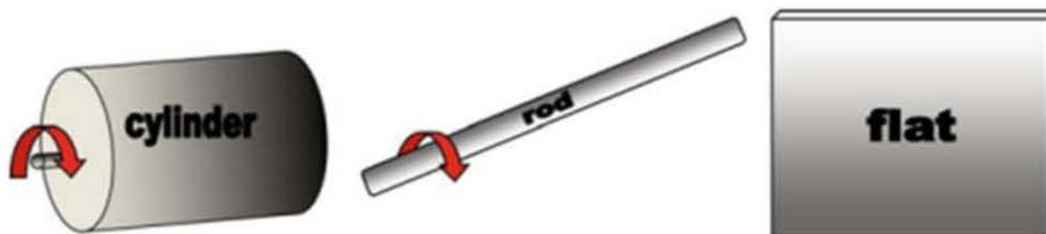
**Fig.2.11.** Diferentes tipos de colectores que permiten obtener diferentes morfologías de los andamios.
