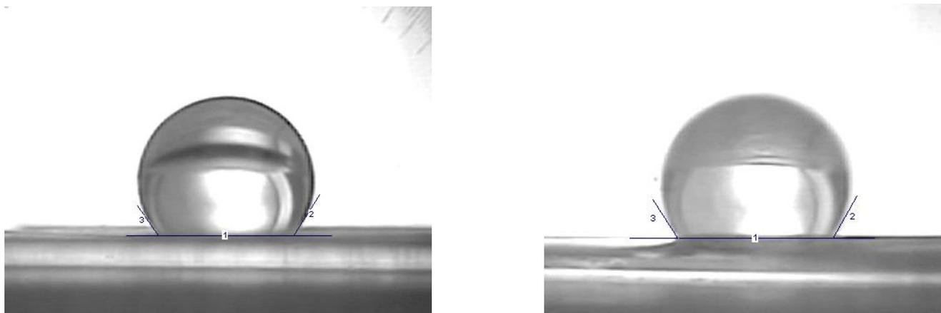
**Fig. 4.46.** Medición de ángulos de contacto. Se muestra una gota de 8  $\mu$ L de agua deionizada sobre la superficie de un andamio de PCL-biovidrio. Las imágenes son representativas de todos los casos aquí estudiados.
