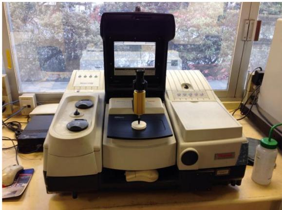
**Fig. 3.3.** Equipo de infrarrojo con transformada de Fourier. Espectrómetro Thermo Scientific Nicolet 6700.<sup>[13]</sup>
