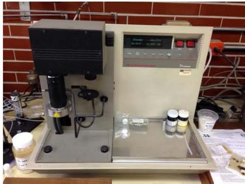
**Fig. 3.9.** Analizador termogravimétrico de alta resolución TGA 2950 de TA Instruments.<sup>[13]</sup>
