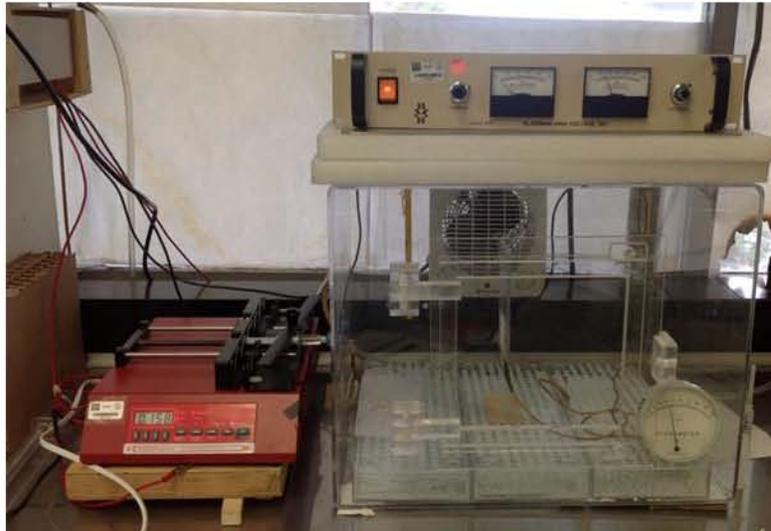
**Fig.3.15.** Equipo de electrohilado. <sup>[13]</sup>
