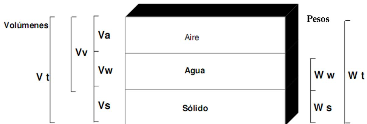
Figura 2.1 Diagrama de diferenciación de volúmenes y masas de una muestra de suelo.
