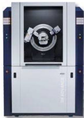
Figura 3.4: Se muestra el equipo Bruker D8 Advance utilizado para obtener DRX.
