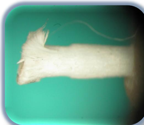
Fig. 56. Poste de fibra de vidrio Angelus®. Separación y flexión de las fibras de vidrio.
