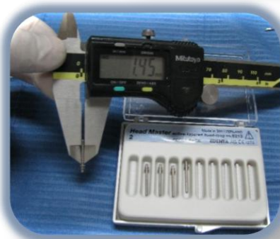
Fig. 25. Calibración del grupo (C) fibra de vidrio Angelus®.
