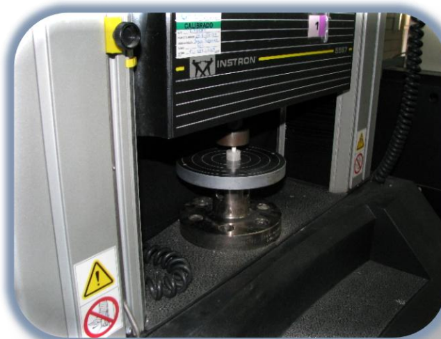
Fig. 46. Aproximación de la celda de compresión al poste de la muestra.
