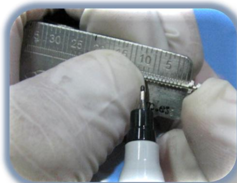
Fig. 30 y 31. Marcaje de los postes antes de córtalos.
