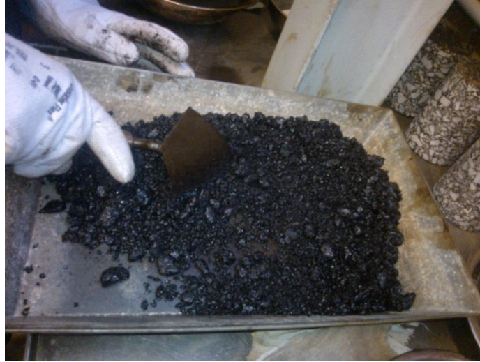
Figura 3.7. Mezcla asfáltica suelta para densidad de Rice
