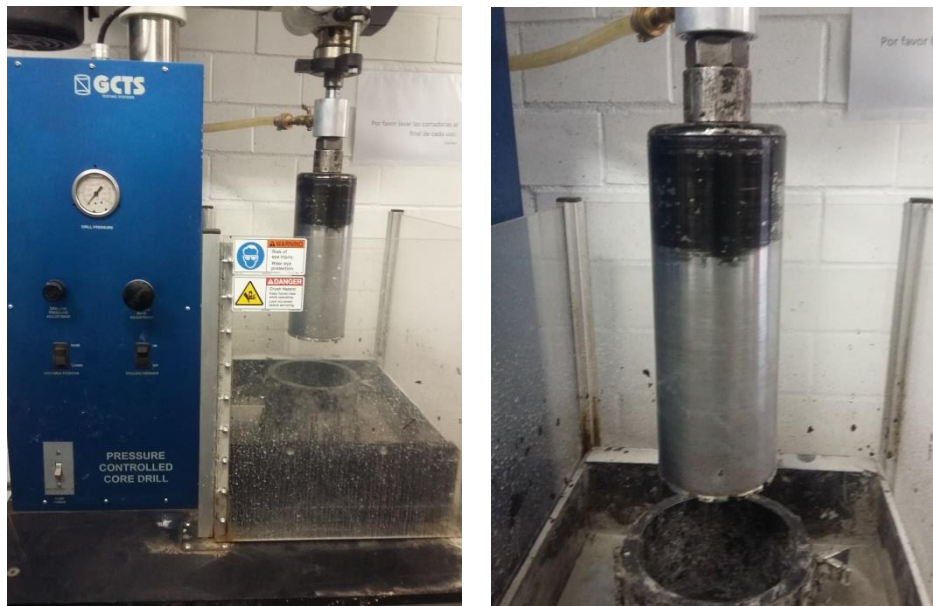
Figura 3.13. Extractor de núcleos de concreto asfáltico
