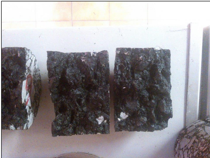
Figura 4.5. Muestra de la falla después del ensayo
