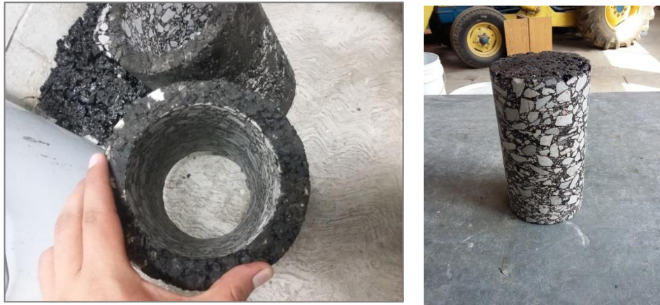
Figura 3.14. Extracción de núcleos
