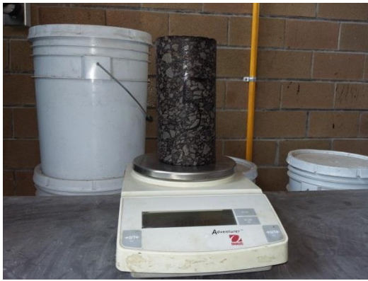
Figura 3.15. Determinación de la densidad bruta Gmb
