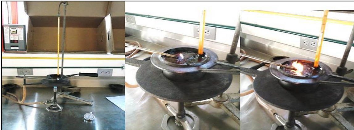
Figura 2.22. Ensayo de punto de inflamación (Martínez, O., 2014)
