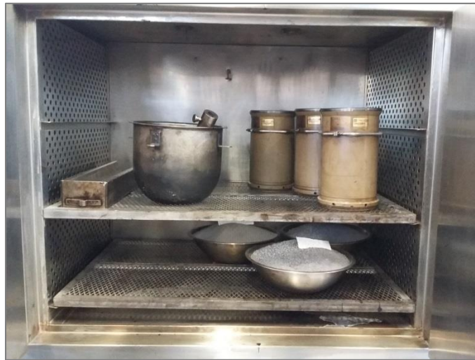
Figura 3.9. Preparación de los instrumentos y el agregado para la mezcla
