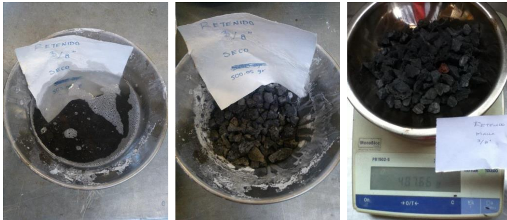
Figura 2.15. Proceso del intemperismo acelerado (Josephia, R., 2015)
