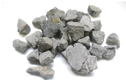
Figura 2.10. Agregado grueso con caras fracturadas (Martínez, O., 2014)
