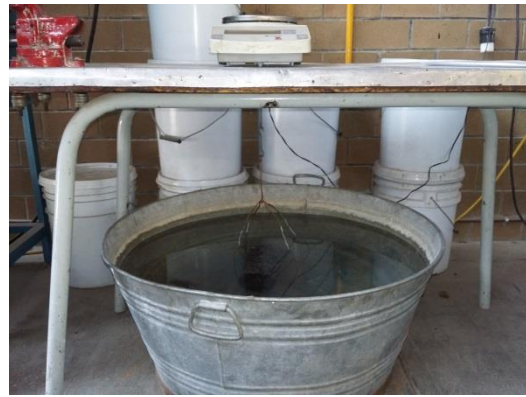
Figura 3.15. Determinación de la densidad bruta Gmb
