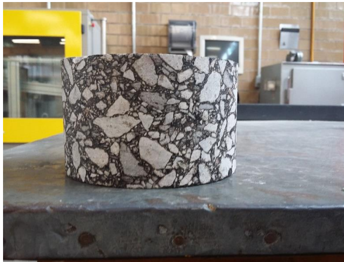
Figura 2.4. Mezcla asfáltica compactada densa elaborada en laboratorio
