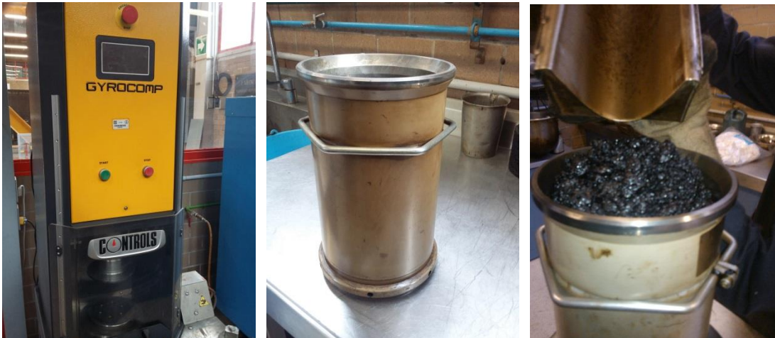
Figura 3.10. Compactación de la mezcla asfáltica
