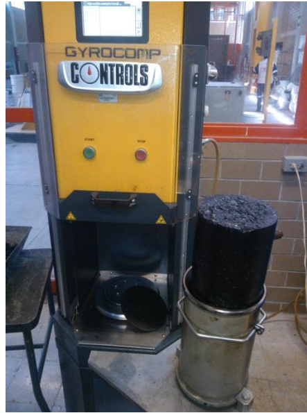
Figura 3.12. Extracción de la mezcla compactada
