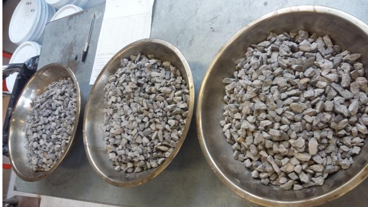
Figura 3.5. Dosificación de material pétreo
