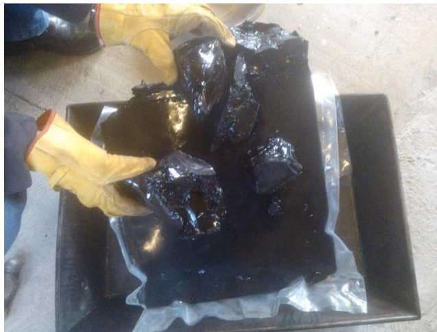
Figura 3.6. Preparación del cemento asfáltico
