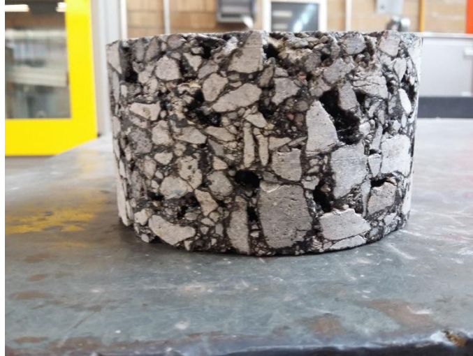
Figura 2.5. Mezcla asfáltica compactada abierta elaborada en laboratorio
