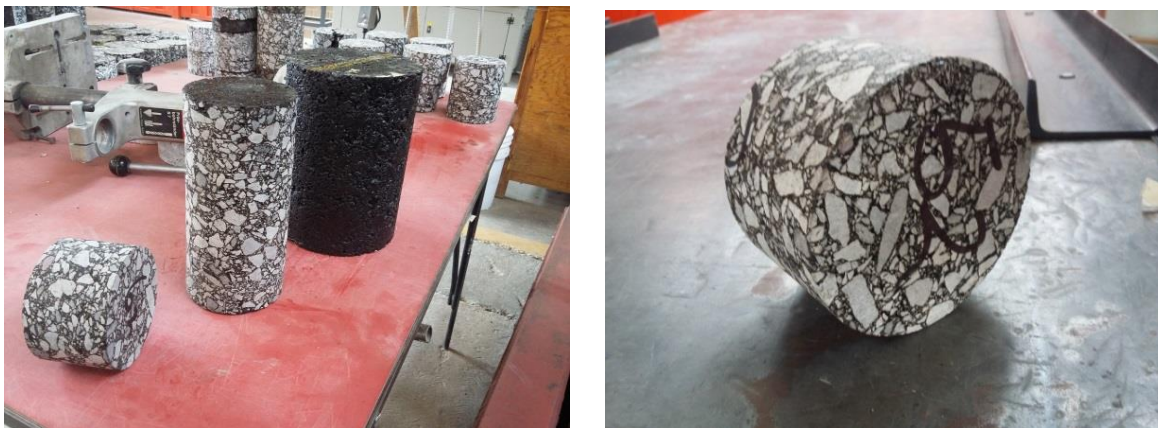
a) Especímen de prueba, núcleo extraído y cilindro compactado
