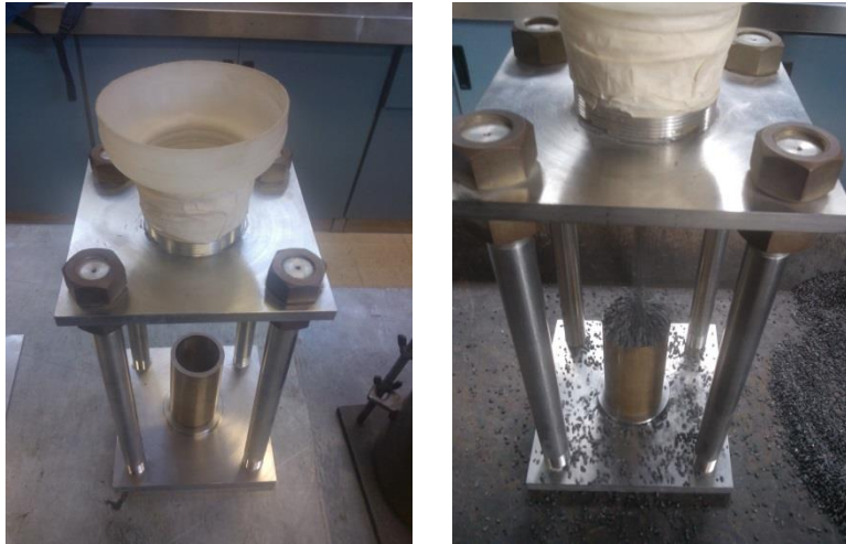
Figura 2.11. Dispositivo para la angularidad del agregado fino (Josephia, R., 2015)
