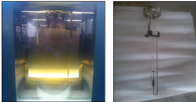
Figura 2.19. Ensayo de viscosidad cinemática (Josephia, R., 2015)
