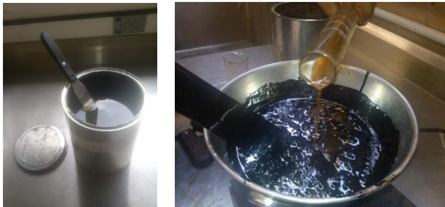
Figura 2.2. Mezcla asfáltica tibia elaborada en laboratorio con aditivo (Josephia, R., 2015)
