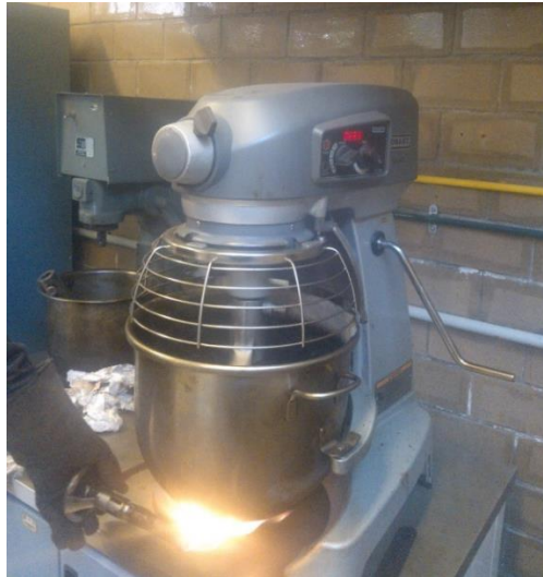
Figura 2.1. Mezcla asfáltica caliente elaborada en laboratorio
