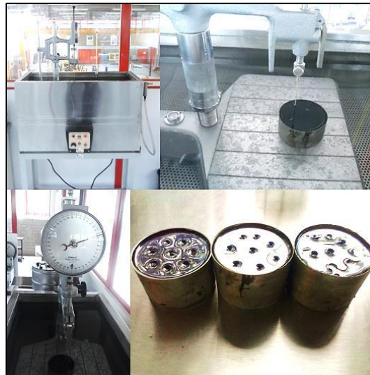
Figura 2.21. Ensayo de penetración del cemento asfáltico (Martínez, O., 2014)
