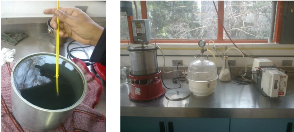
Figura 3.8. Picnómetro con mezcla (izquierda) y sistema de desaire de la mezcla (derecha)
