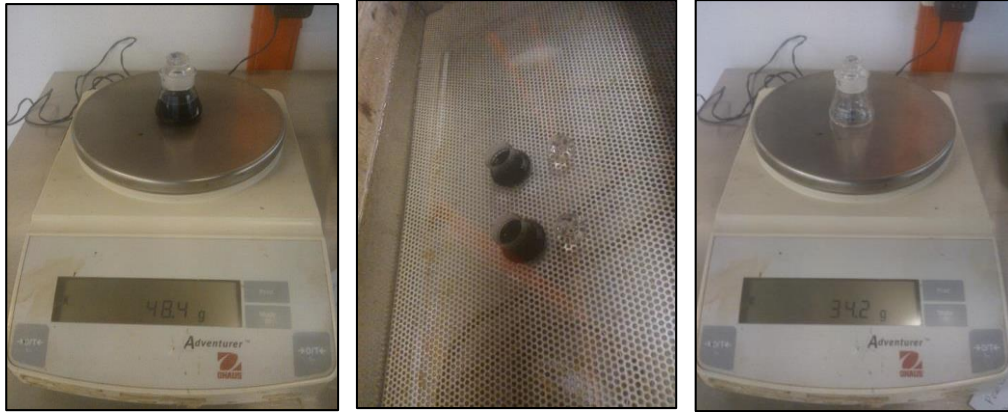
Figura 2.26. Determinación del peso específico del cemento asfáltico (Josephia, R., 2015)
