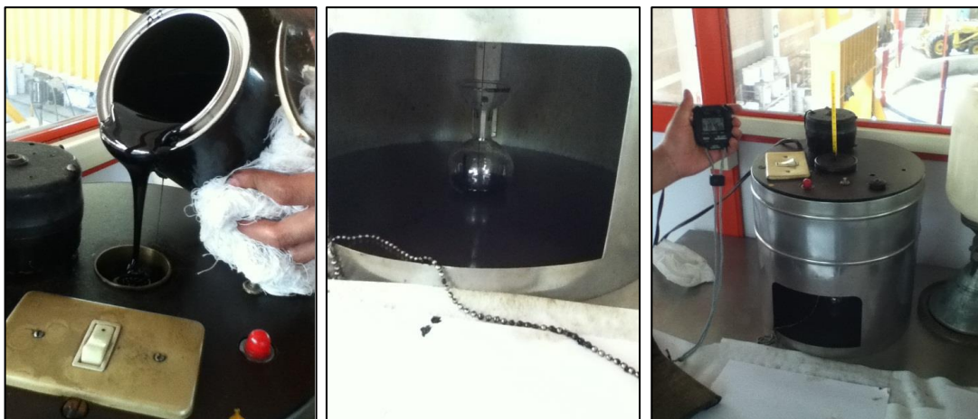
Figura 2.23. Ensayo de viscosidad Saybolt-Furol (Josephia, R., 2015)
