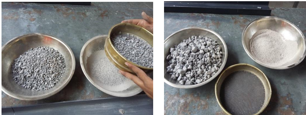
Figura 2.14. Material pétreo cribado después del desgaste
