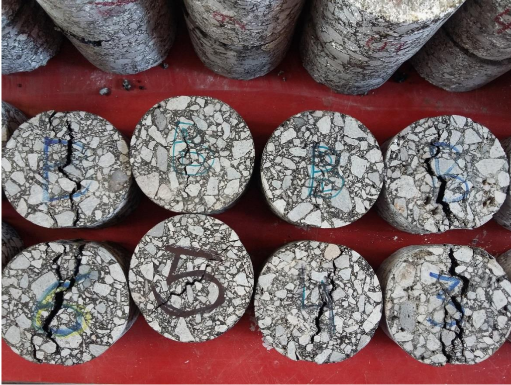
Figura 4.4. Grietas de falla en especímenes ensayados
