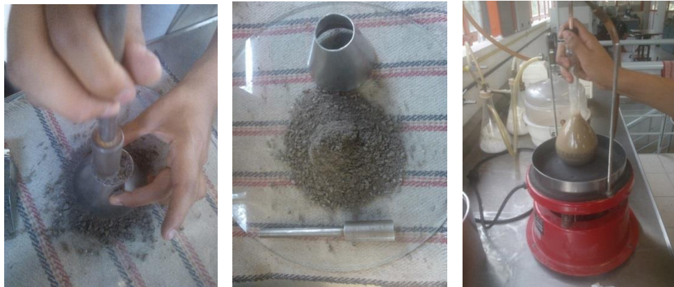
Figura 2.17. Determinación de la gravedad específica del agregado fino (Josephia, R., 2015)
