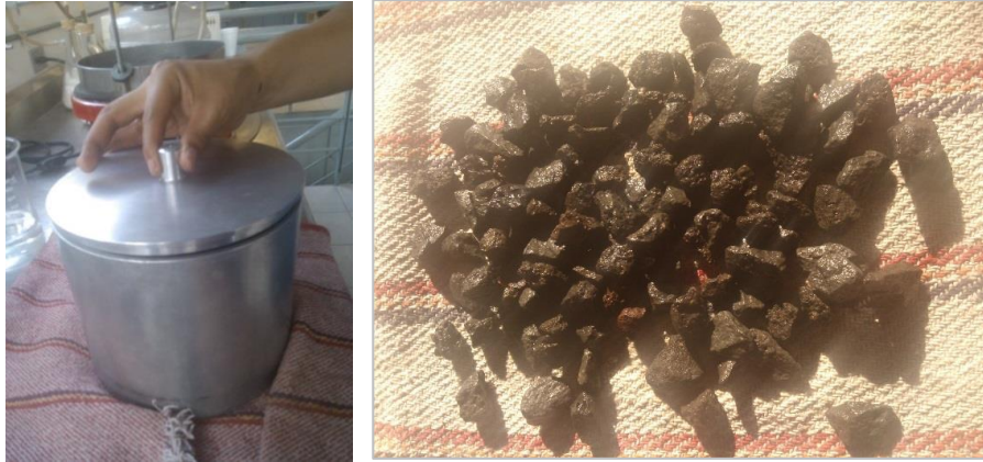
Figura 2.16. Determinación de la gravedad específica del agregado grueso (Josephia, R., 2015)
