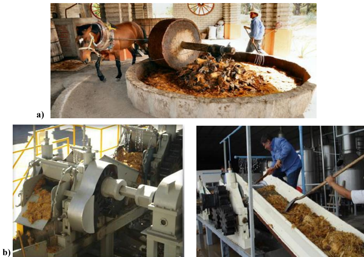
Figura 3.7. Diferentes tipos de molienda. a) Molinos artesanales, b) Prensas para triturar las piñas cocidas de agave en plantas de producción.
