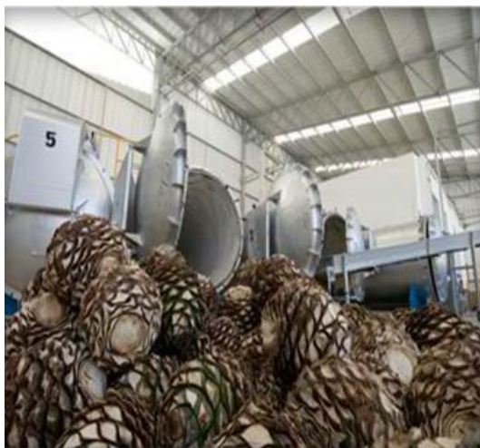
Figura 3.6. Piñas de Agave listas para cocerse en autoclaves de acero inoxidable.
