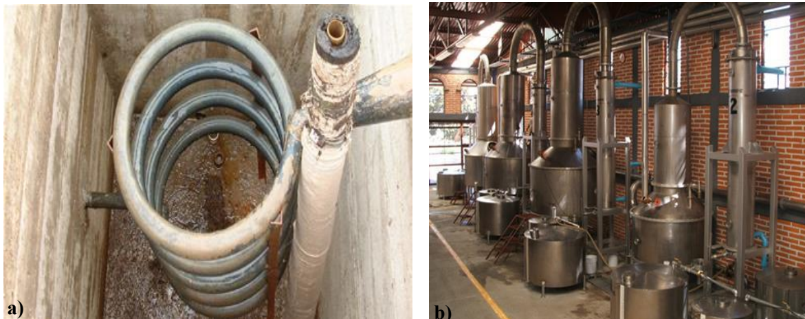
Figura 3.9. a) Alambique de serpentín (tomado de Ávila Reyes, 2010), b) Destiladores de acero inoxidable.
