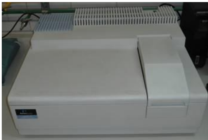
Figura 4.1. Espectrofotómetro UV-VIS Perkin Elmer, Lambda 35 de doble haz.
