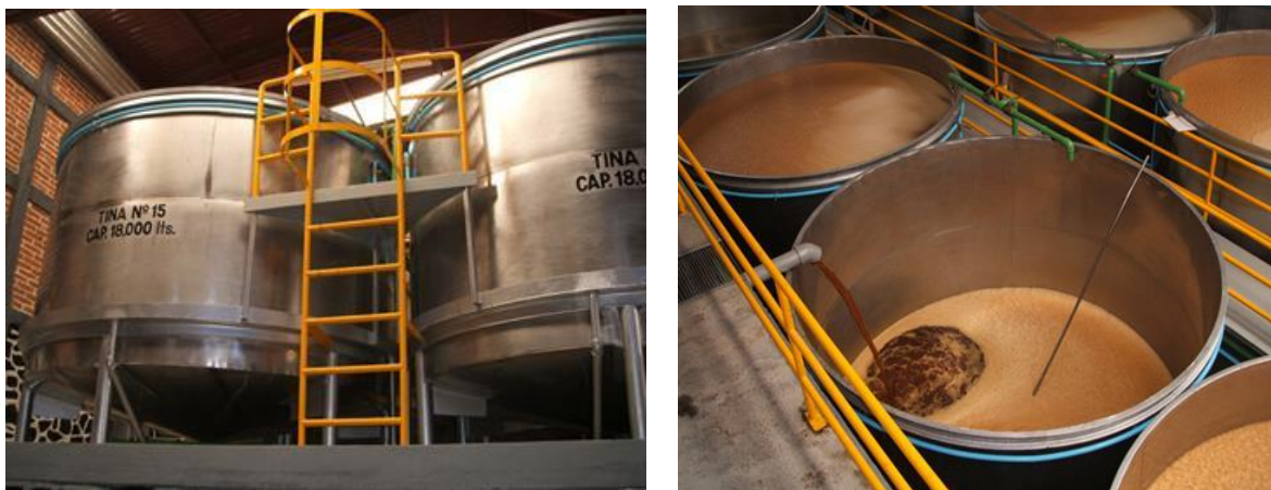
Figura 3.8. Tanques fermentadores de acero inoxidable.
