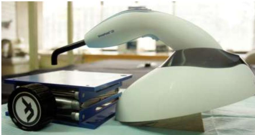
Ilustración 2. Soporte de altura variable para realizar pruebas de profundidad y flexión.
