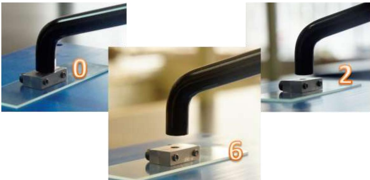
Ilustración 4. Diferentes distancias muestra-punta lámpara utilizadas en las pruebas. (0, 2 y 6 mm)
