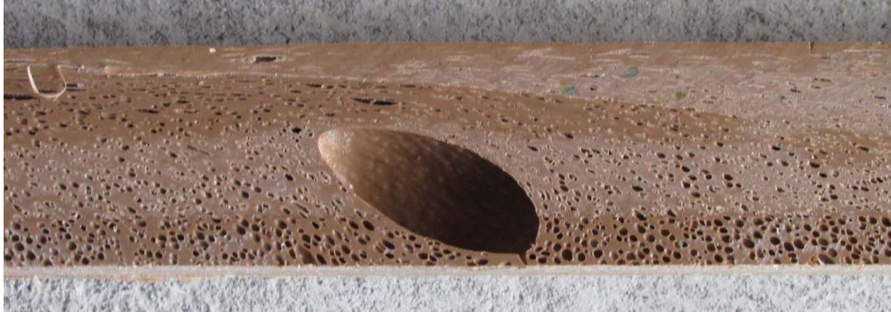
Ilustración 22: Imperfecciones de la madera plástica ensayada
