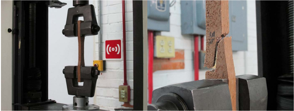
Ilustración 21: Fractura de las probetas
