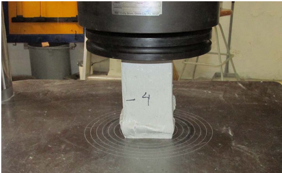
Ilustración 17: Deformación de la probeta 4
