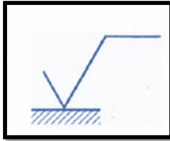
Figura 34. Acabado superficial adicional.
