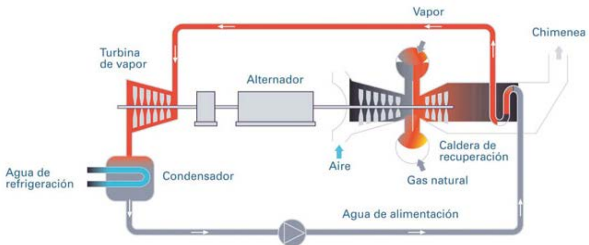
Figura 2.8 Ciclo con turbina de vapor (12)
