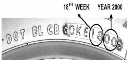
Ilustración 42 Identificación de la Fecha de Fabricación de los Neumáticos
