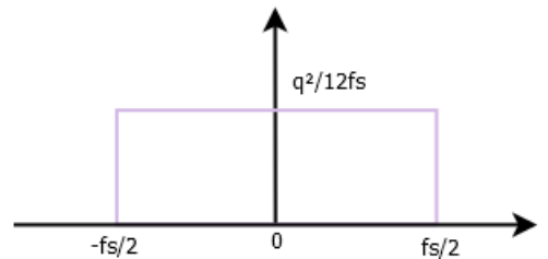
FIGURA 2.6: Densidad espectral de potencia del ruido de cuantización.
