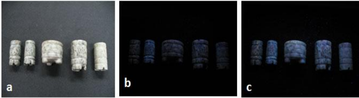
Figura 149. Análisis con Fluorescencia de luz UV en piedra verde jaspeada con luz normal (a) onda corta (b) y onda larga (c).
