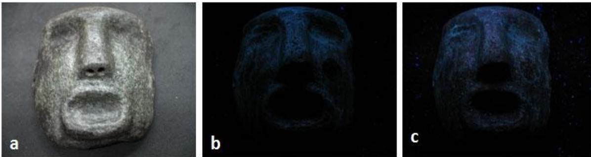
Figura 151. Análisis con Fluorescencia de luz UV en máscara de piedra verde con luz normal (a) onda corta (b) y onda larga (c).
