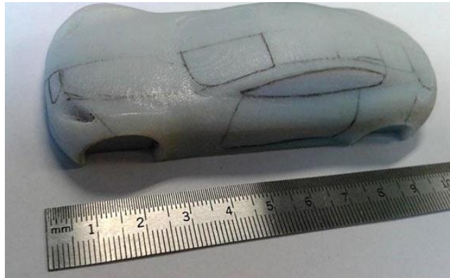
Figura 7 Impresión de chasis por el método FDM
