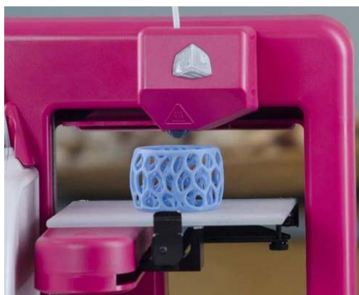
FIG. 2 PIEZA FABRICADA POR IMPRESIÓN TRIDIMENSIONAL.
