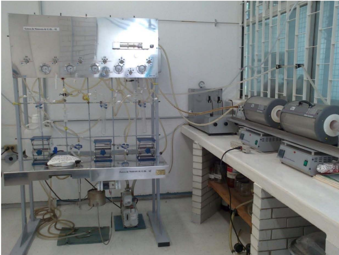
Figura 10. Línea de síntesis de benceno.
