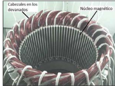
Figura 3.6: Cabezales en los devanados del estator de una máquina de inducción.
