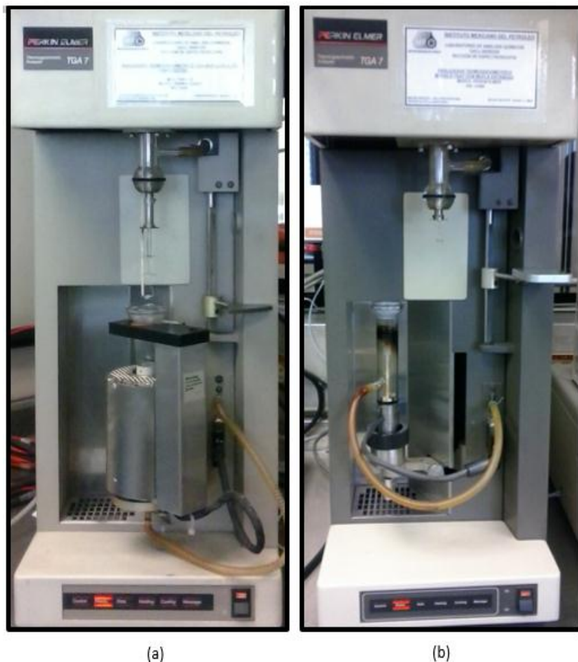
Figura 5-3. Tipos de termogravímetros. a) Termogravímetro de alta temperatura (HT). b) Termogravímetro de temperatura normal.
