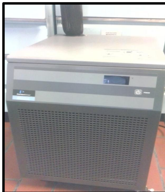
Figura 5-11. Intracooler empleado para las bajas temperaturas.
