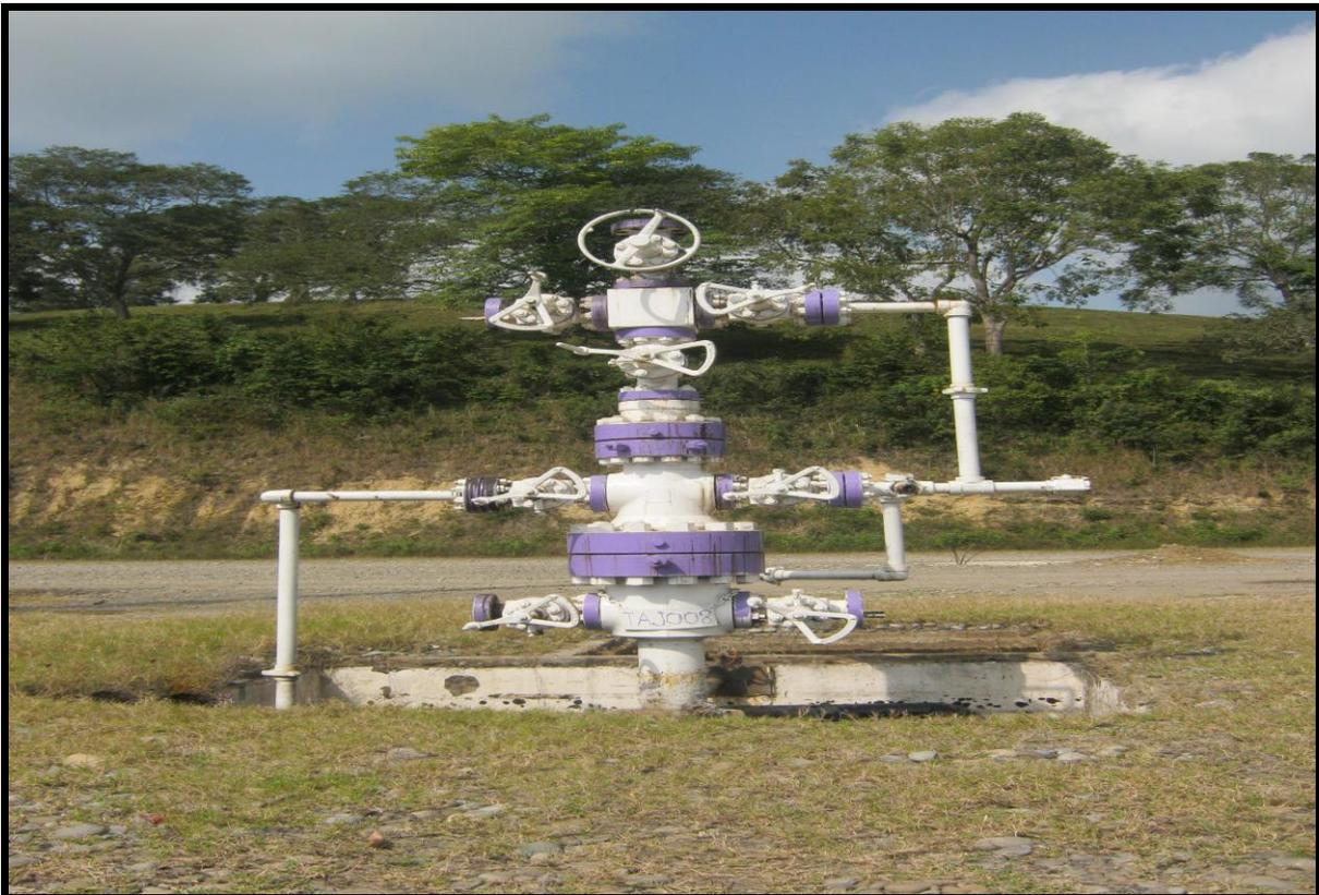
**IMAGEN 2.** Sistema de Bombeo Neumático.
