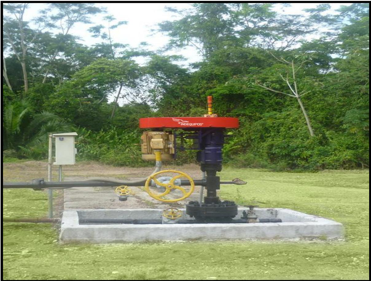
**IMAGEN 3.** Sistema de Bombeo Cavidad Progresiva.
