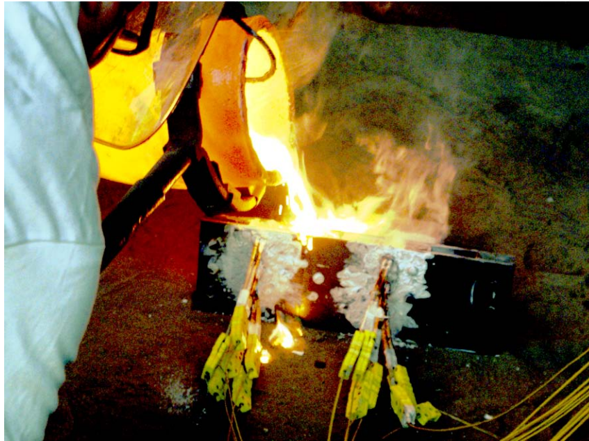
Figura 3.3: Proceso de vaciado en la lingotera vertical instrumentada para obtener los planchones delgados. En la parte frontal se observan los termopares y sus conexiones hacia el módulo de adquisición de datos. También se observa el recubrimiento utilizado, el cual generó porosidad excesiva y contaminación de Si en los planchones delgados.
