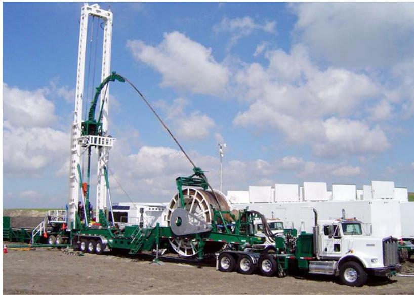
Figura 2.7.- Equipo de perforación de pozos con tubería flexible. (es.jereh-pe.com 2015)
