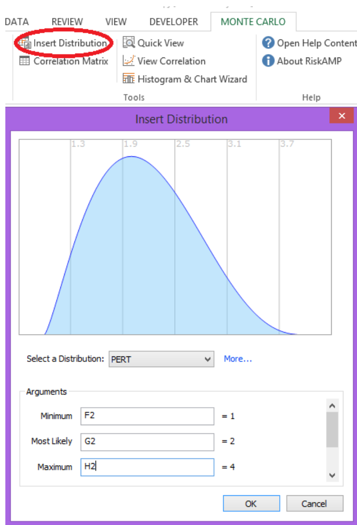
FIGURA 18. SELECCIÓN DE LA DISTRIBUCIÓN PARA LA DURACIÓN DE LAS ACTIVIDADES EN LA SIMULACIÓN MONTE CARLO
