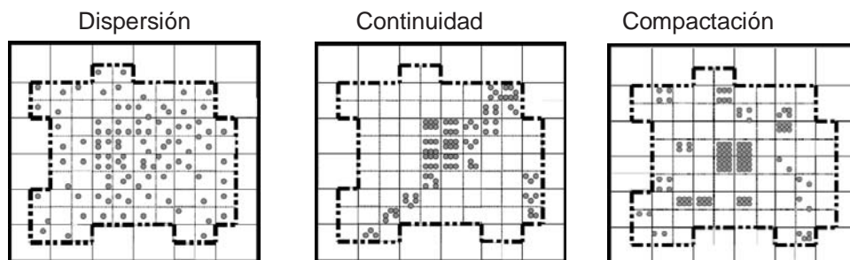
Figura 3.5 Modelos morfológicos de expansión de asentamientos a partir de Galster (2001).
