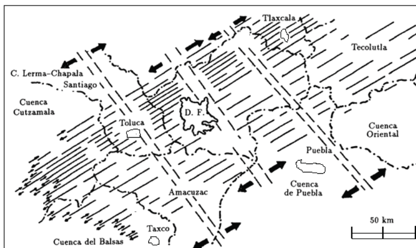
Figura 4.3 Proceso estructural de los valles y cuencas en el cinturón Volcánico Transverso de México.
