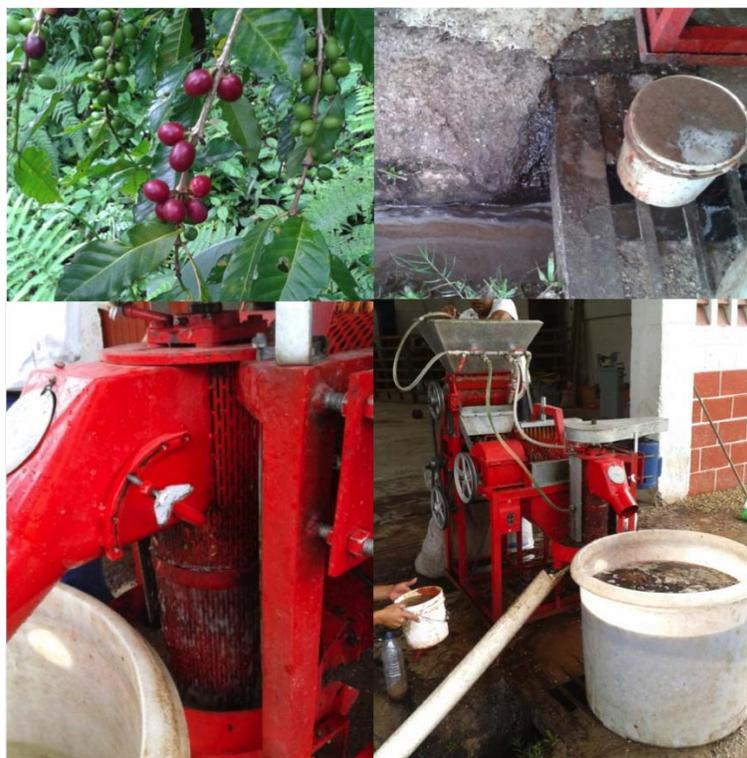
Figura 2.2: Extracción mecánica de mucílago de café.
