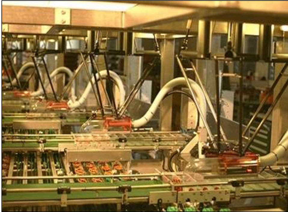
Fig. 1.7 Instalación del Demarex's Line-Placer para empaque de pretzels en una panadería industrial.
