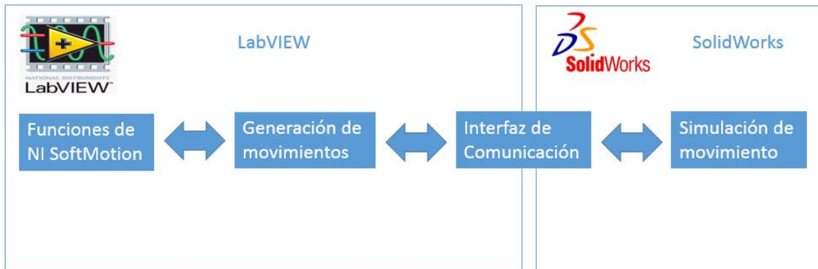
Fig. 3.35 Comunicación entre LabVIEW y SolidWorks.
