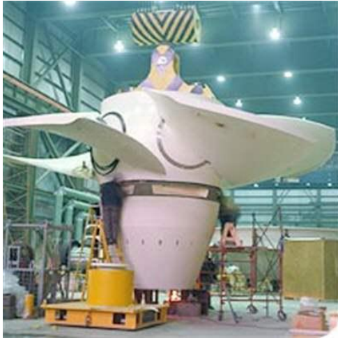
Figura 20: Turbina Kaplan. Ideal para saltos pequeños y grandes caudales.
