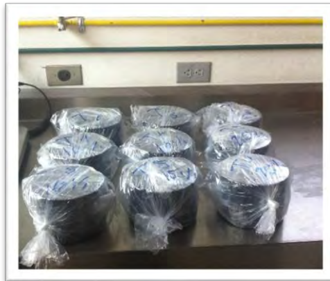
A 1.19 Acondicionamiento de probetas para la prueba de tensión indirecta, etapa de congelamiento
