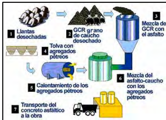
Figura 2.3.1.3. Proceso de modificación por vía húmeda [15].
