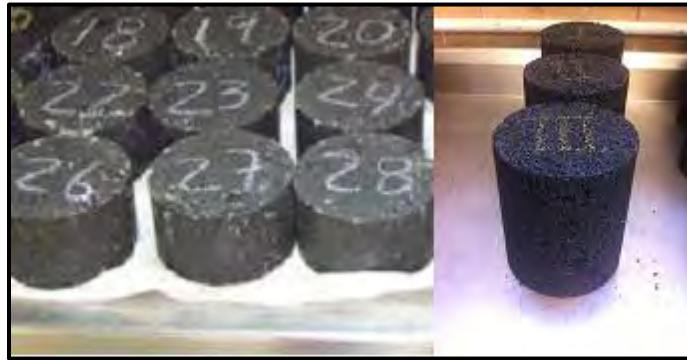
Figura 3.3.3.1. Probetas para la prueba de tensión indirecta (Izq.) y prueba de fractura (Der.).
