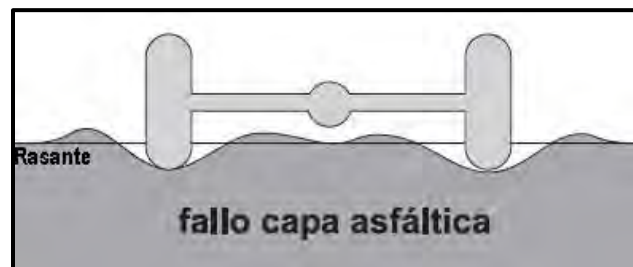
Figura 3.3.2.1. Deformación plástica de una mezcla débil [23].
