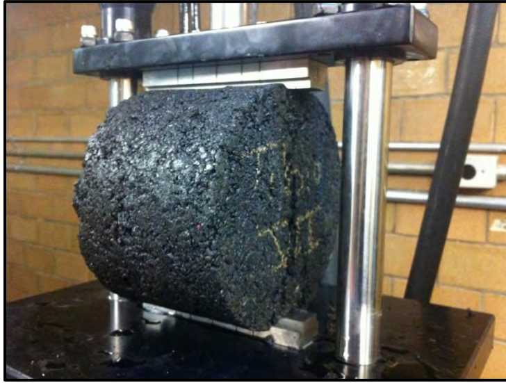
Figura 3.4.2.4. Prueba de tensión indirecta de una mezcla asfáltica tibia.
