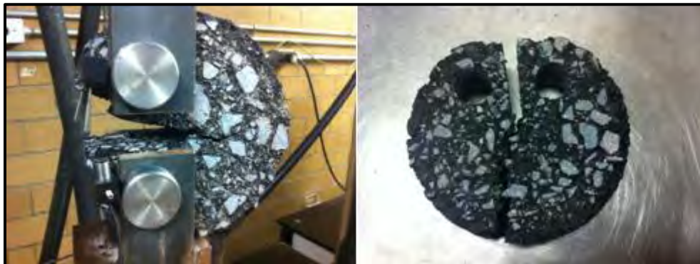
Figura 3.5.2.2. Prueba de fractura.
