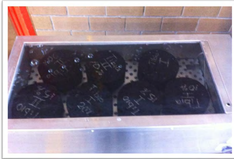
A 1.20 Acondicionamiento de probetas para la prueba de tensión indirecta, etapa de saturación a 25° C
