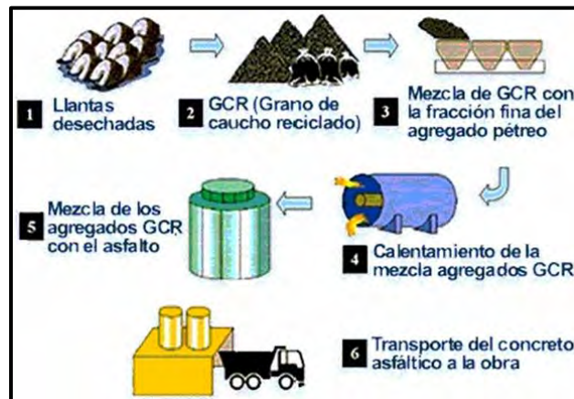
Figura 2.3.1.2. Proceso de modificación por vía seca [15].
