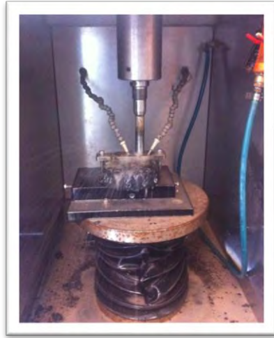
A 1.22 Elaboración de la geometría de las probetas para la prueba de energía de fractura
