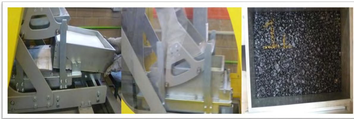
A 1.17 Compactación de probetas para la prueba de deformación permanente
