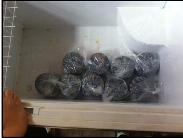
Figura 3.4.2.2. Congelamiento a -18^{\circ}\text{C} por 16 horas.
