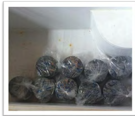
A 1.19 Acondicionamiento de probetas para la prueba de tensión indirecta, etapa de congelamiento
