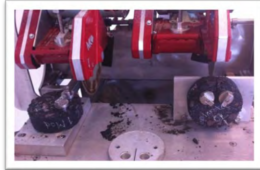
A 1.22 Elaboración de la geometría de las probetas para la prueba de energía de fractura
