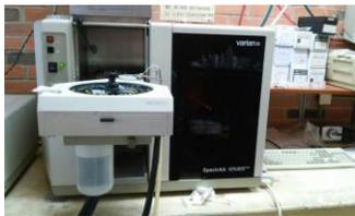
Figura 3. Espectrofotómetro de absorción atómica (EAA) acoplado con horno de grafito (Varian).
