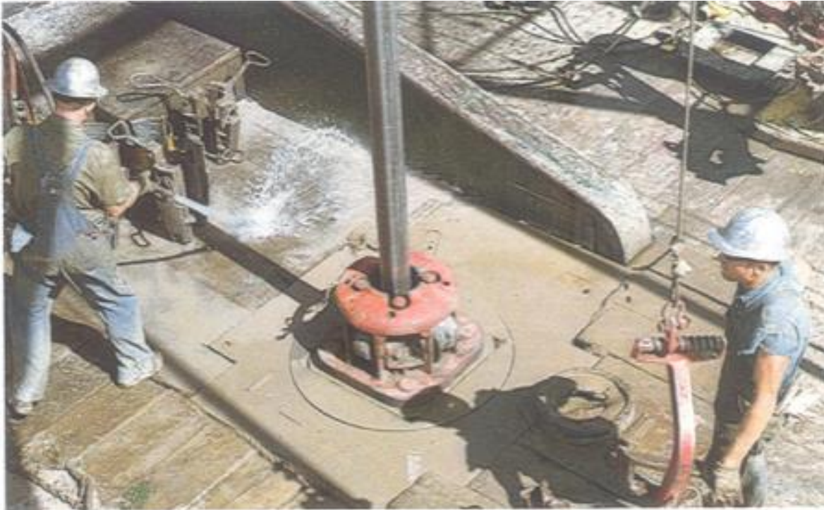
Figura 6.9 Este cuadrante de cuatro lados pasa a través del buje del cuadrante que esta sentado dentro del buje maestro (20)
