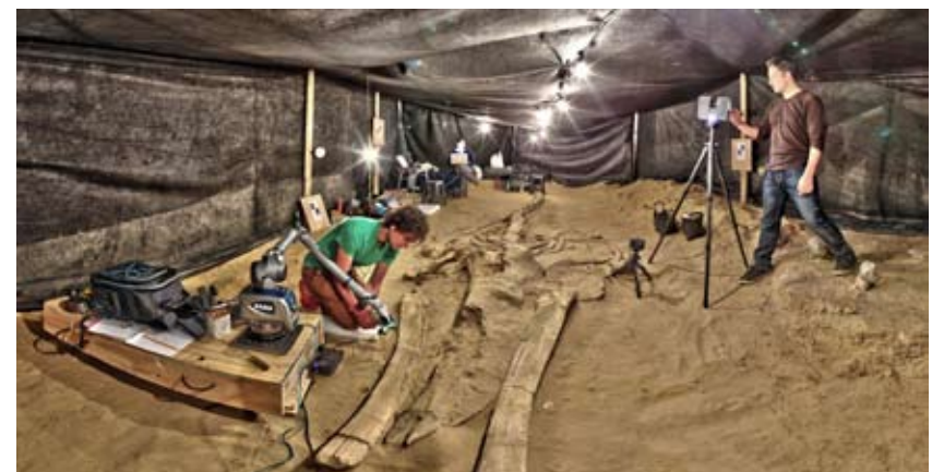
FIGURA 3.20 Documentación arqueológica con escáner láser 3D del Instituto Smithsonian.
