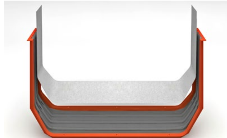
2.- Colocación de refuerzo de fibra de vidrio
