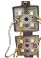
Circuito de 2 módulos Led de 4 Leds 5050 c/u
