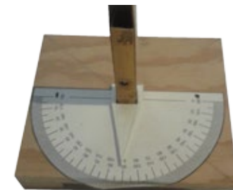
Base y poste giratorio de simulador con registro angular
