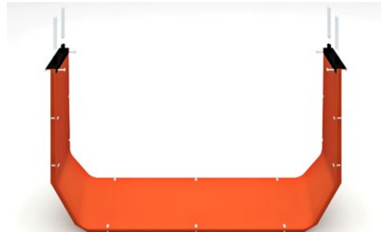
4.- Colocación de varillas para su ahogado.
