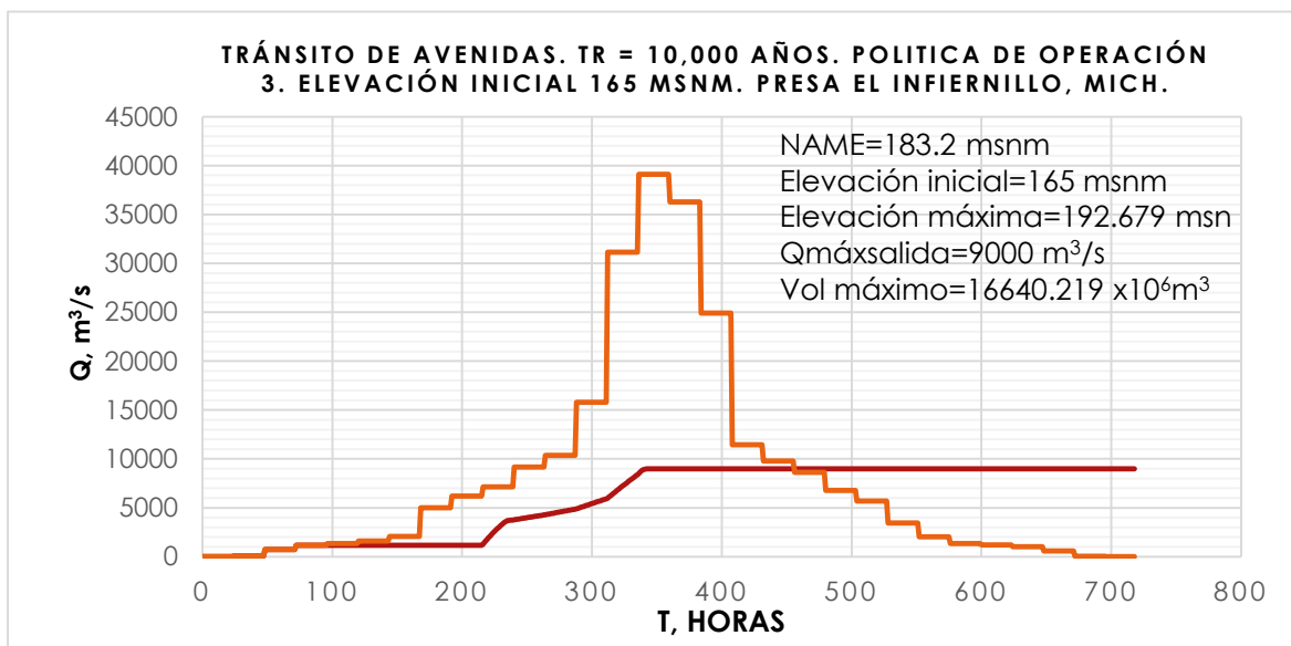
FIGURA 5.16. POLÍTICA DE OPERACIÓN CON LOS 3 VERTEDORES ABIERTOS
