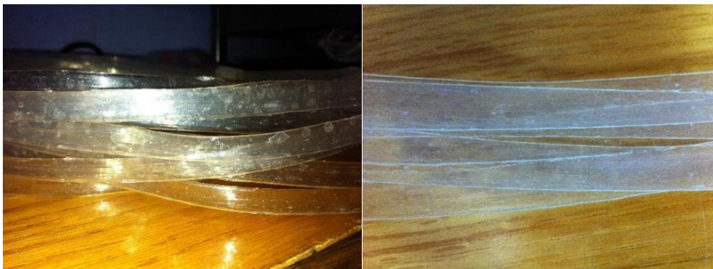
Figura 44. Primeros perfiles de PLA obtenidos con el dado de perfil rectangular.
