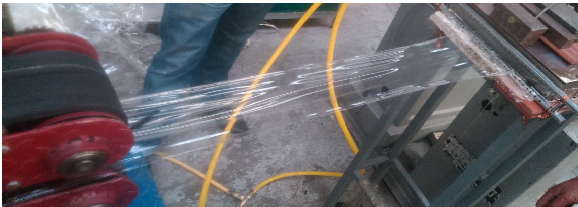
Figura 63. Extrusión de la película de PLA.
