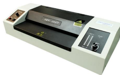
Figura 72. Equipo de laminado térmico utilizado para pruebas de adhesión PLA-papel.
