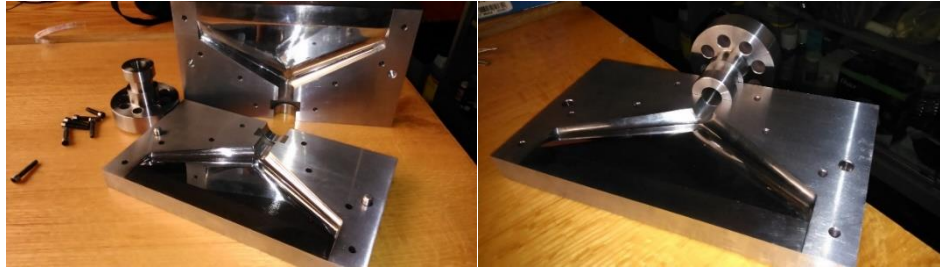
Figura 57. Dado de extrusión plano manufacturado.
