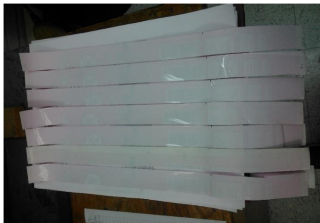
Figura 74. Muestras de material bicapa con dimensiones requeridas por la norma ASTM para ensayos de separación.
