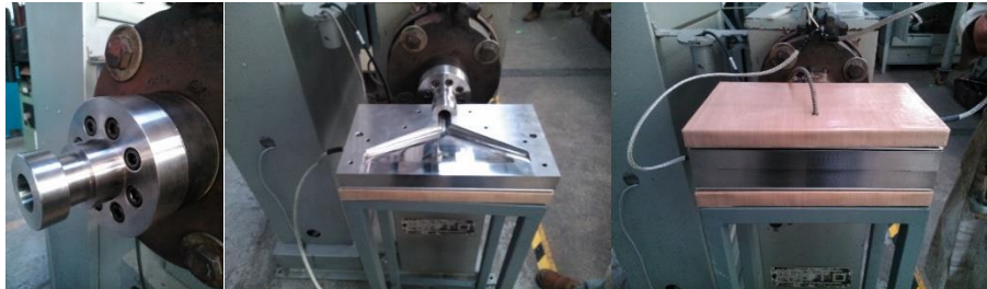
Figura 59. Montaje del dado plano de extrusión en el laboratorio de procesamiento de plástico.
