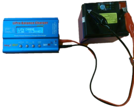
Cargador LiPro Balance conectado a la batería
