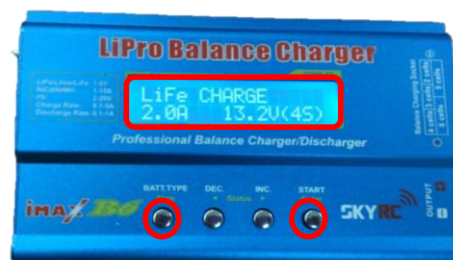
Cargador LiPro Balance en modo LiFe Charge
